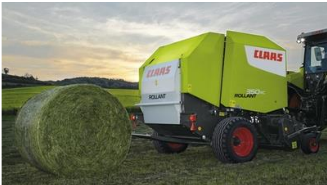
Slika 3. Preša Claas Rollant 350 RC i bala omotana mrežnom folijom
