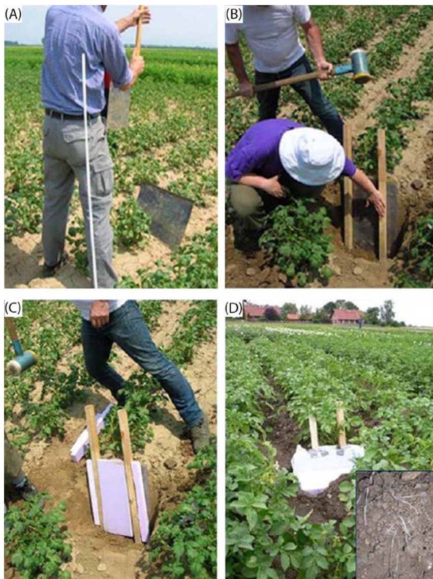
Slika 4 Postavljanje prozora za promatranje korijena u polju krumpira. (A) Otvaranje profila tla pomoću čelične ploče; (B) Zamjena čelične ploče prozorom za promatranje od pleksiglasa; (C) Fiksacija i izolacija prozora za promatranje; (D) Prozor za promatranje korijena u polju 3 tjedna nakon postavljanja s razvijenim novim korijenjem (Neumann et al., 2009).
