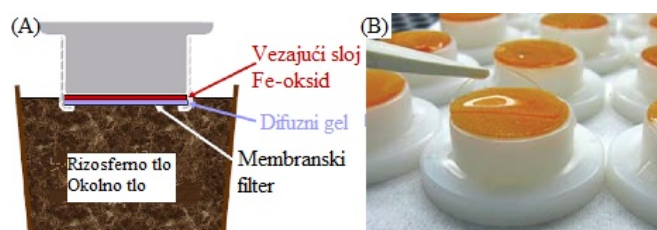
Slika 26 DGT uređaj. (A) Shematski prikaz mjerenja prikazuje uređaj postavljen na vlažno tlo kroz određeni vremenski period (obično 20-24h) (Wenzel, 2014); (B) Komponente uključuju vezajući sloj (narančasto) i prozirni difuzni gel. Membranski filter, koji ovdje nije prikazan, smješten je na vrhu (Mason, 2016). Preuredila D. Erić, 2016.
