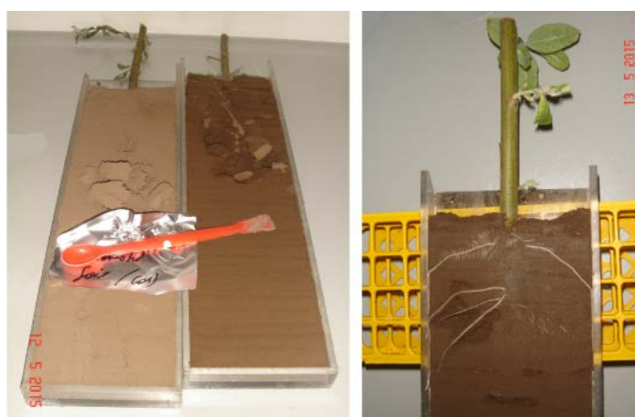
Slika 13 Rizotron sustav s akrilnim prozorom za promatranje dinamike rasta i razvoja korijena (Zgorelec, 2015).
