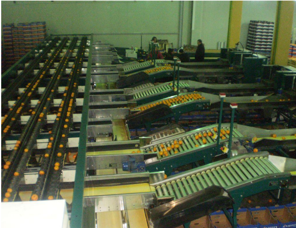
Slika 5. Kalibrator (izradio autor)
