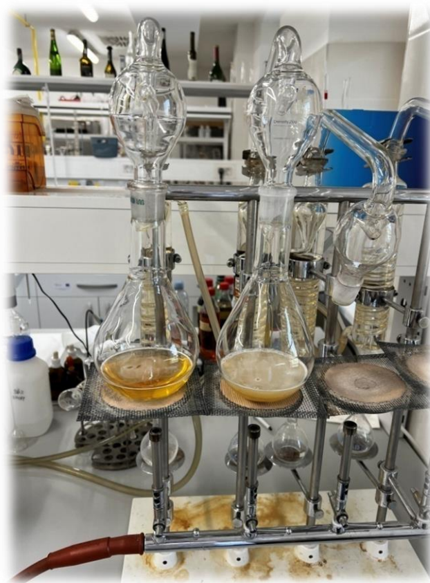
Slika 7. Destilacija vina u Kjeldahovoj tikvici (07.03.2023)
