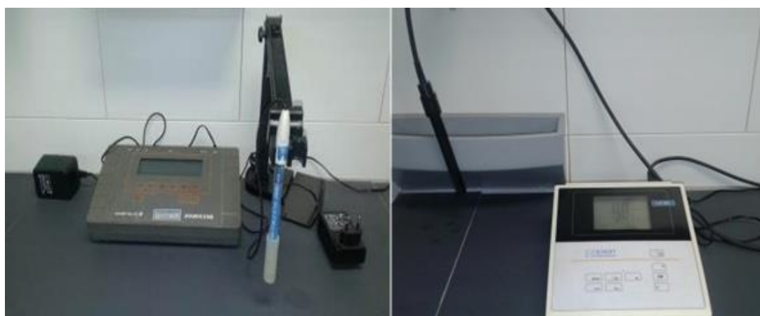
Slika 10. Analitički instrumenti za određivanje pH i EC (Perčin, 2015).
