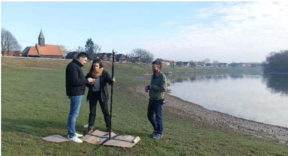
Slika 12. Postavljanje georeferentne točke za kasniju obradu modela i georeferenciranje na području Letovanića u sklopu EWAP projekta
