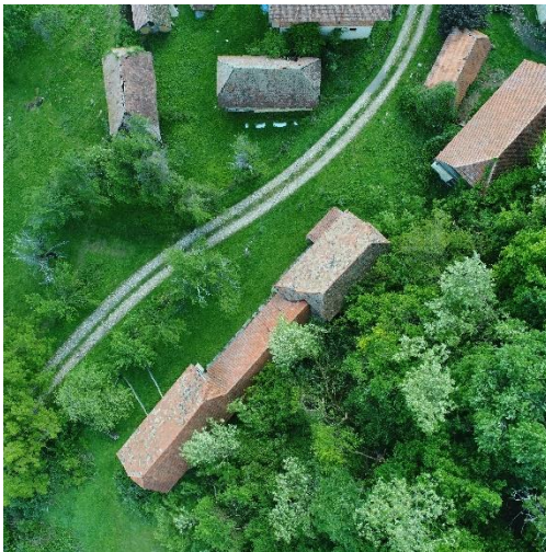
Slika 9. Primjer fotografija letjelice br. 1, ortogonalnog fotografiranja i preklopa od 80% sa svih strana fotografije
