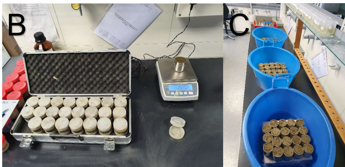
Slika 8. Određivanje fizikalnih svojstava tla: A – uzimanje neporušenih uzoraka tla u polju; B – vaganje uzoraka u laboratoriju; C – postupno postizanje maksimalne zasićenosti uzoraka tla vodom (izvor: L. Brezinščak)
