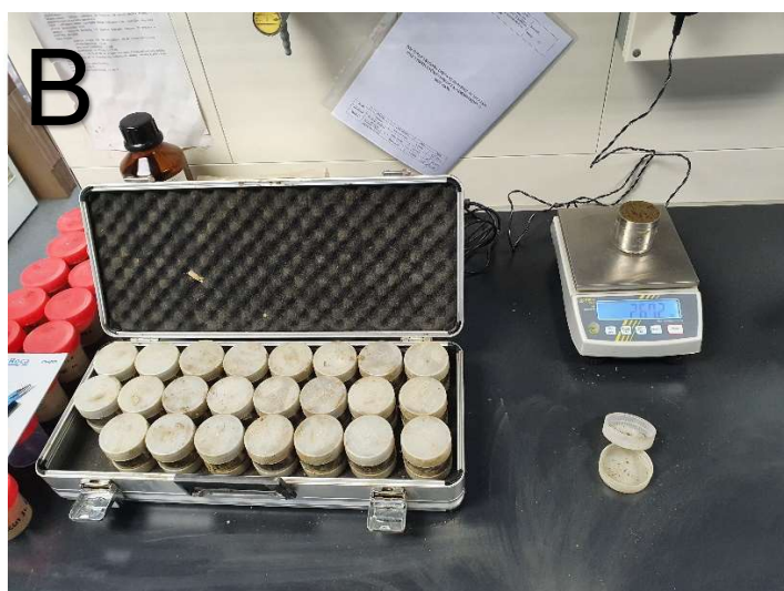
Slika 8. Određivanje fizikalnih svojstava tla: A – uzimanje neporušenih uzoraka tla u polju; B – vaganje uzoraka u laboratoriju; C – postupno postizanje maksimalne zasićenosti uzoraka tla vodom (izvor: L. Brezinščak)
