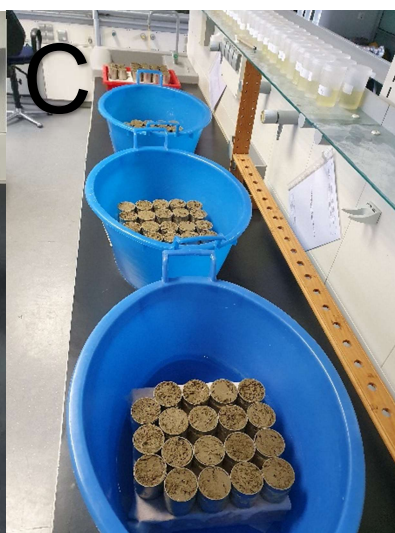
Slika 8. Određivanje fizikalnih svojstava tla: A – uzimanje neporušenih uzoraka tla u polju; B – vaganje uzoraka u laboratoriju; C – postupno postizanje maksimalne zasićenosti uzoraka tla vodom (izvor: L. Brezinščak)
