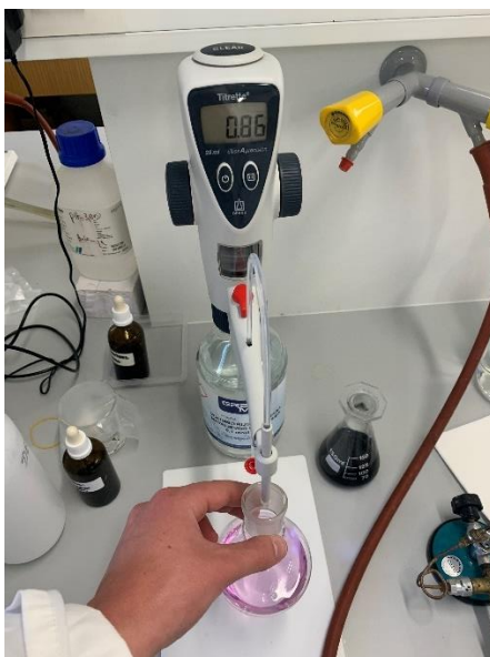
Slika 8 Titracija uzorka, izvor fotografije: autor
