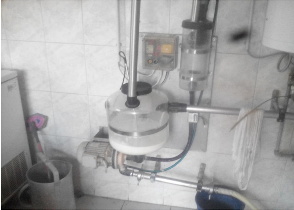
Slika 15. Prihvatna komora i sanitarni lonac (Foto: Švub)
