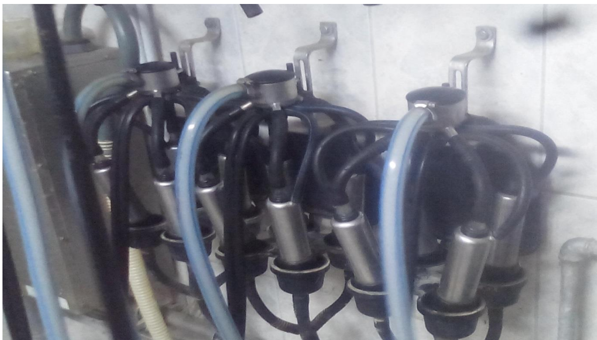
Slika 19. Postolje za muzne jedinice (Foto: Švub)
