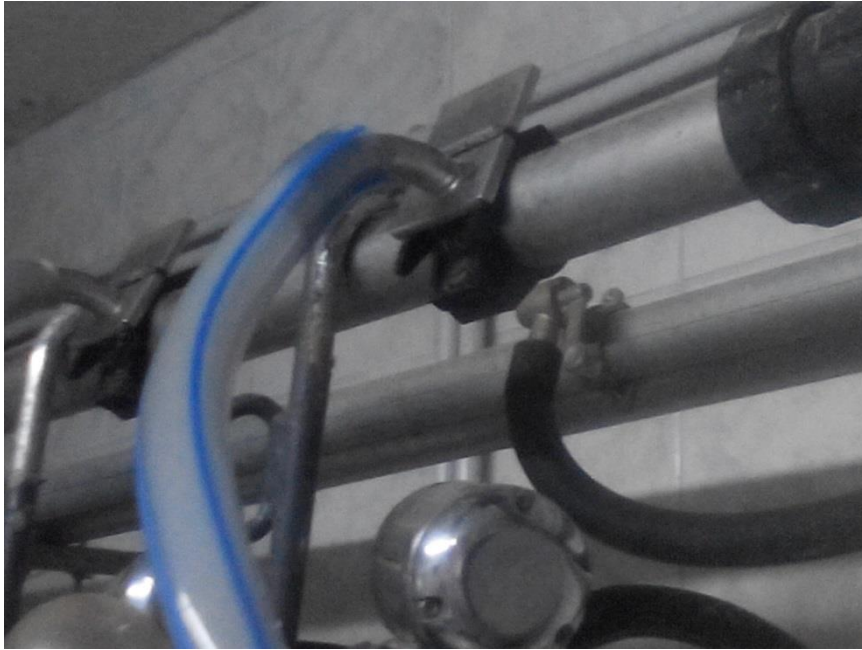
Slika 17. Brzospajajuće spojnice za mlijeko i zrak (Foto: Švub)
