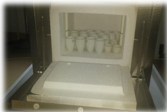
Slika 12. Mufolna pećnica (Slikala: Martina Pejić)
