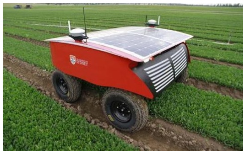
Slika 42. Kemijsko suzbijanje korova robotom tipa Rippa, (Ćosić, 2021).
