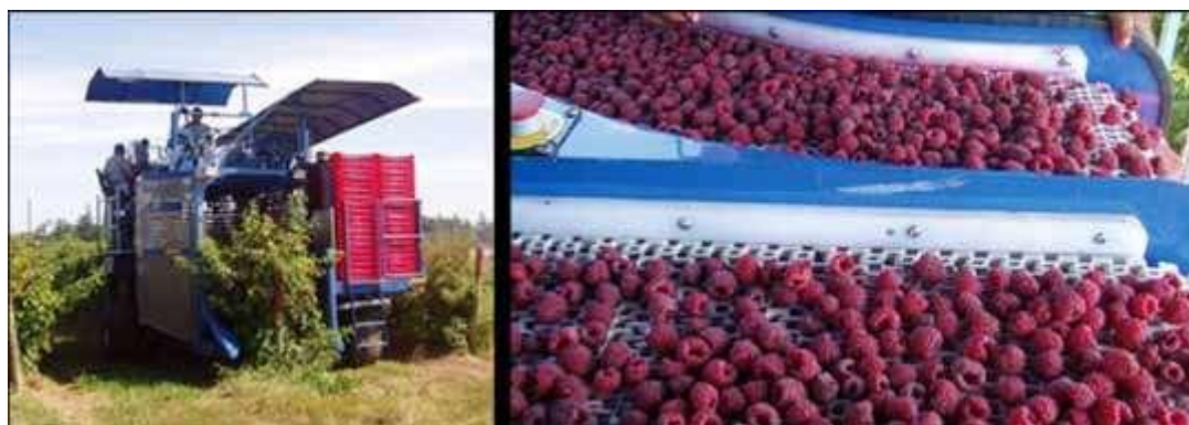
Slika 28. Kombajn za berbu malina (Jatoi et al. 2017).
