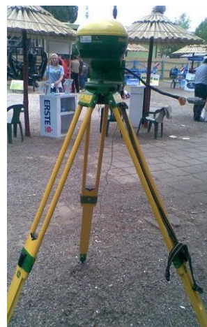
Slika 23. RTK mobilna stanica (Ćosić, 2021).
