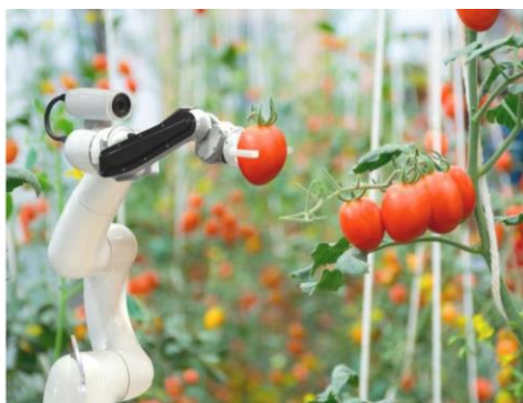
Slika 37. Robotska ruka bere rajčice (Ćosić, 2021).
