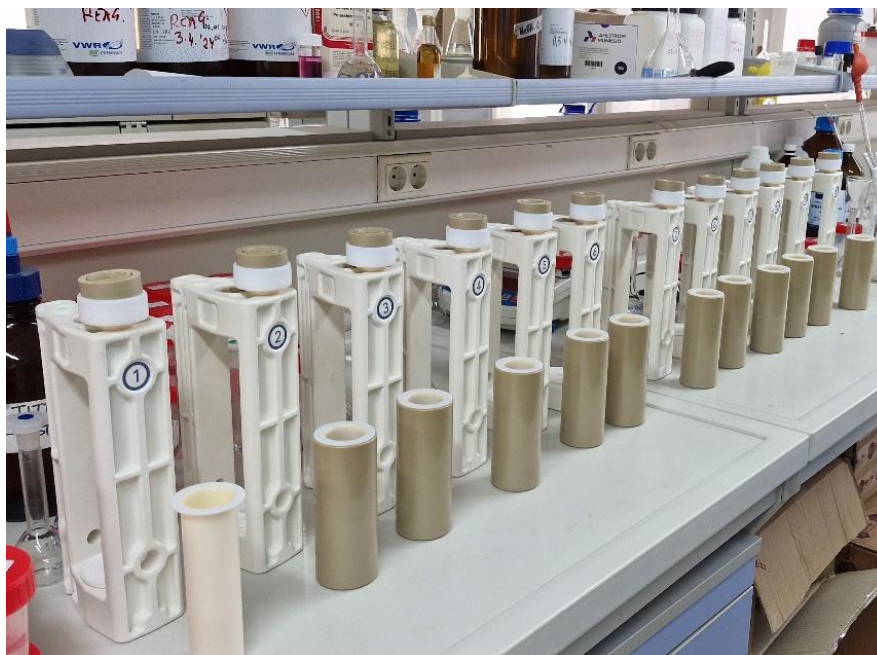
Slika 13. Priprema uzoraka za mikrovalnu digestiju
