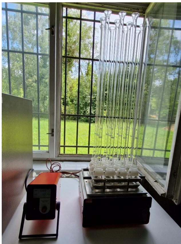
Slika 11. KPK titrirajući reaktor za zagrijavanje
