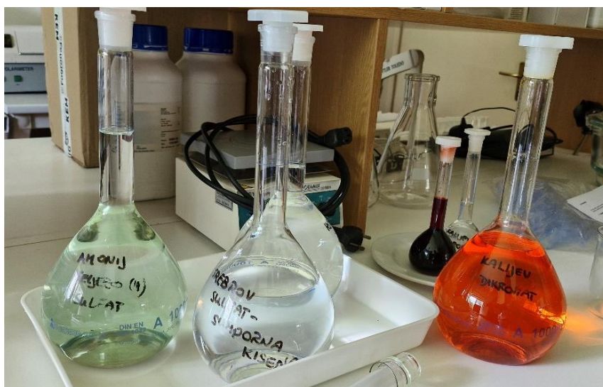
Slika 10. Reagensi za KPK ( kalijev dikromat, srebrov sulfat-sumporna kiselina, amonij željezo(II) sulfat, indikator ferroin)
