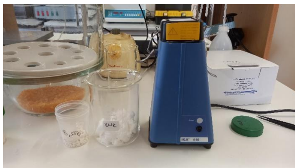
Slika 12. (s lijeva na desno) Uzorak prije razvlaknjivanja, uzorak nakon razvlaknjivanja, laboratorijski mlin
