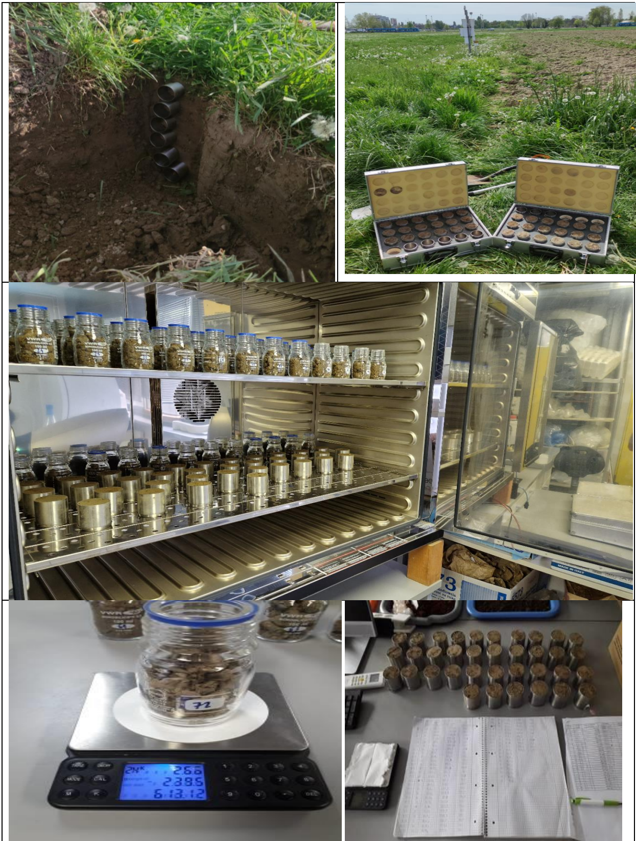
Slike 3.3. Postupak uzimanja uzoraka tla u (ne)porušenom stanju za gravimetrijsku metodu mjerenja vlage u tlu, njihova pohrana u transportne kutije, sušenje uzoraka i unos podataka
