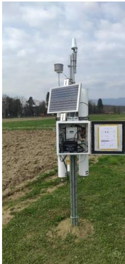
Slika 3.1. Prikaz instaliranog CRNS uređaja na pokušalištu Maksimir (Sveučilište u Zagrebu Agronomski fakultet) Izvor: Ondrašek (2024.)
