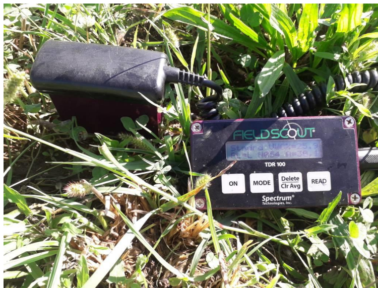
Slika 4.1. TDR metoda mjerenja vode u tlu
