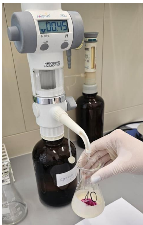
Slika 3.1.3. Titracija natrijevim hidroksidom (NaOH)
