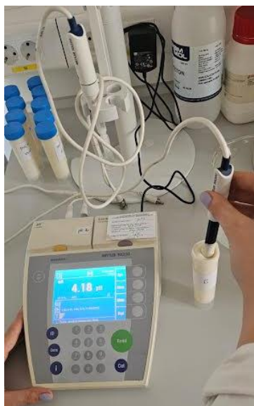
Slika 3.1.1. Mjerenje pH vrhnja na uređaju Mettler Toledo
