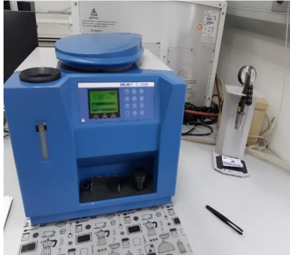
Slika 12. Određivanje ogrjevne vrijednosti uz pomoć kalorimetar (vlastiti izvor)
