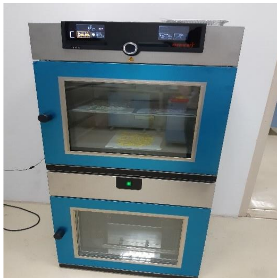
Slika 8. Sušenje cvjetova u laboratorijskoj vakuum sušnici na temperaturi od 50 °C (vlastiti izvor)
