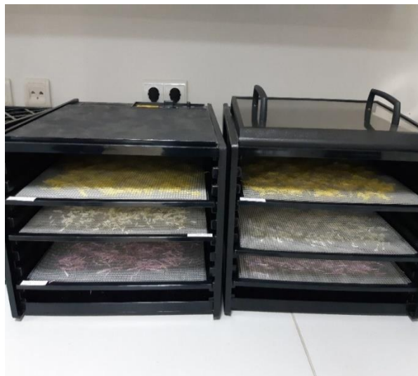
Slika 6. Sušenje cvjetova u laboratorijskom dehidratoru (vlastiti izvor)
