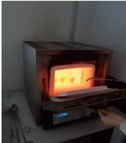
Slika 11. Sagorijevanje uzorka krizanteme u mufolnoj pećnici (vlastiti izvor)
