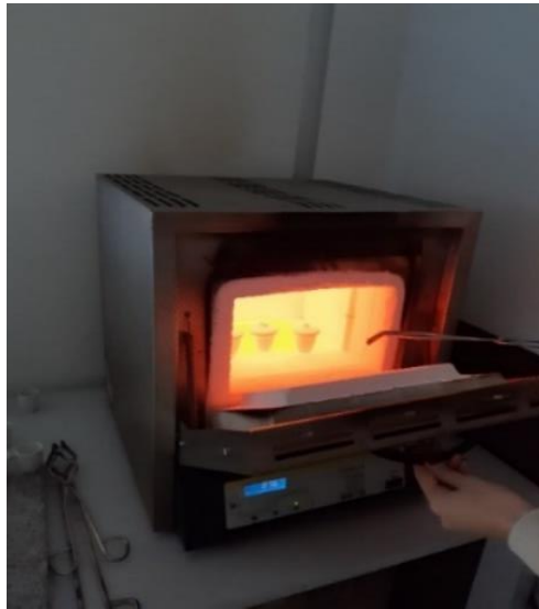
Slika 11. Sagorijevanje uzorka krizanteme u mufolnoj pećnici (vlastiti izvor)
