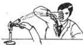
Slika 3. Nepravilno zagrijavanje epruvete
