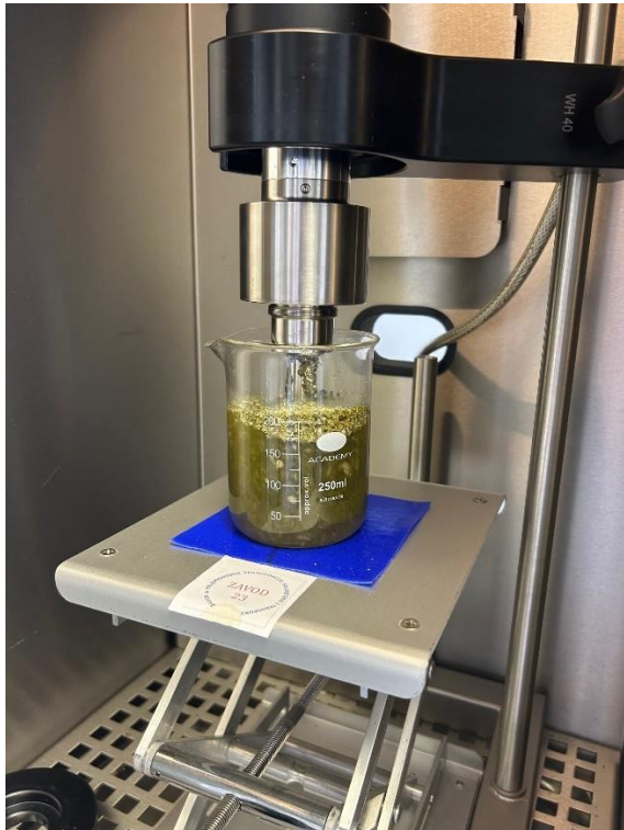
Slika 3.4.1. Ultrazvukom potpomognuta ekstrakcija sa sustavom izravne sonde Autor: Novosel A., 2024.
