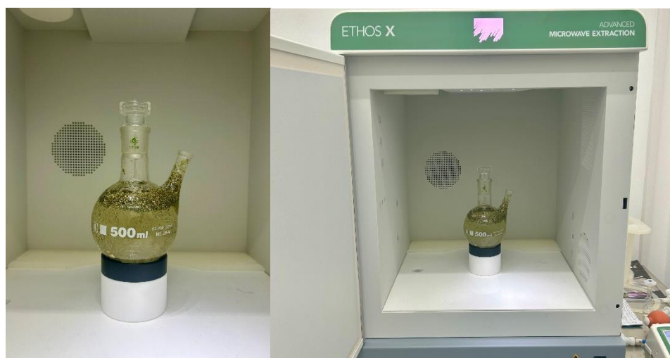
Slika 3.3.1. Mikrovalno potpomognuta ekstrakcija Autor: Novosel A., 2024.
