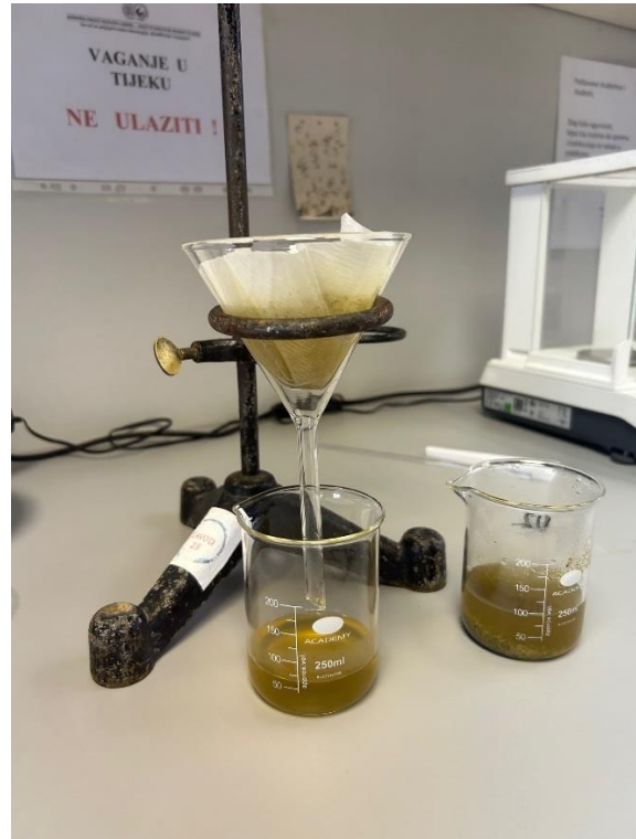
Slika 3.4.2. Filtracija dobivenih ekstrakata Autor: Novosel A., 2024.
