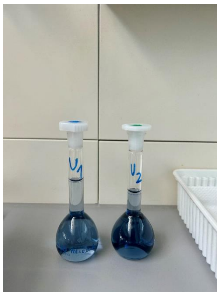
Slika 3.5.3.1. Pripremljeni uzorci za određivanje flavonoida i neflavonoida
