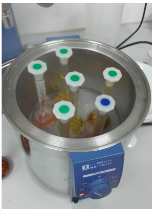
Slika 15: Prikaz kuhanja uzoraka u parnoj kupelji
