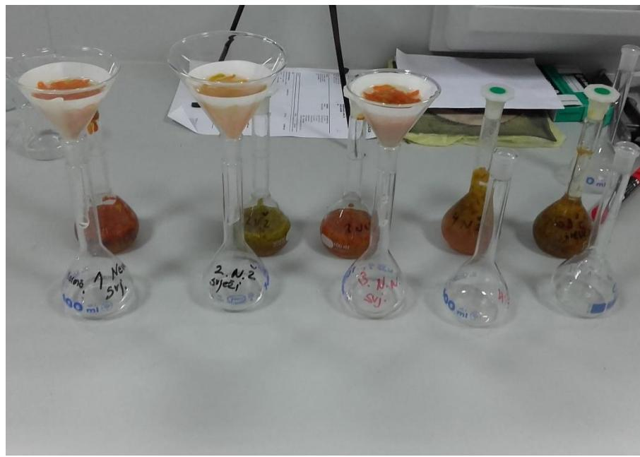
Slika 16: Prikaz filtriranja uzorka za postupak određivanja škroba u polarimetru
