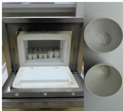
Slika 13: Mufolna pećnica i porculanske posudice sa spaljenim uzorkom
