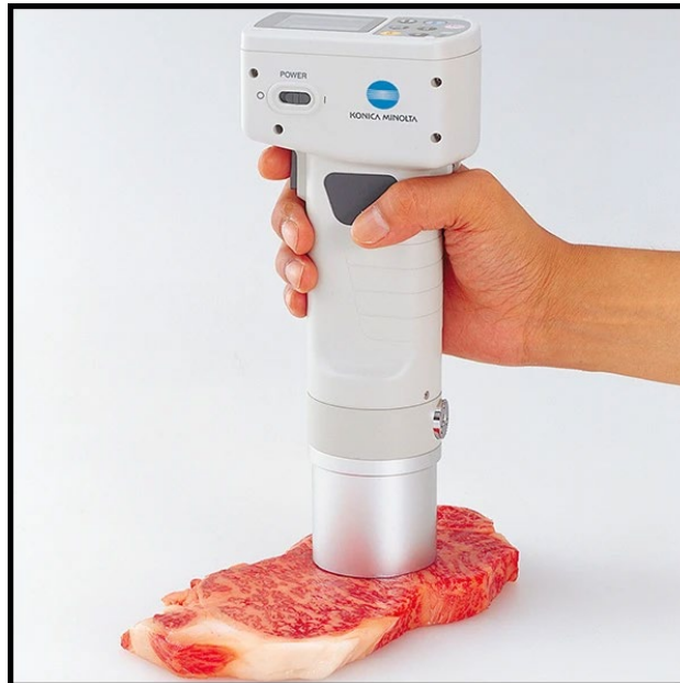
Slika 2.3 : Uređaj za mjerenje boje mesa Izvor: https://sensing.konicaminolta.asia/
