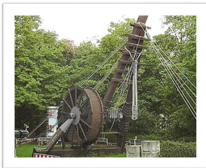
Slika 17. Rimska dizalice visine 10 metara u parku u Njemačkoj, rekonstrukcija. Izvor: Amirante, 2018.
