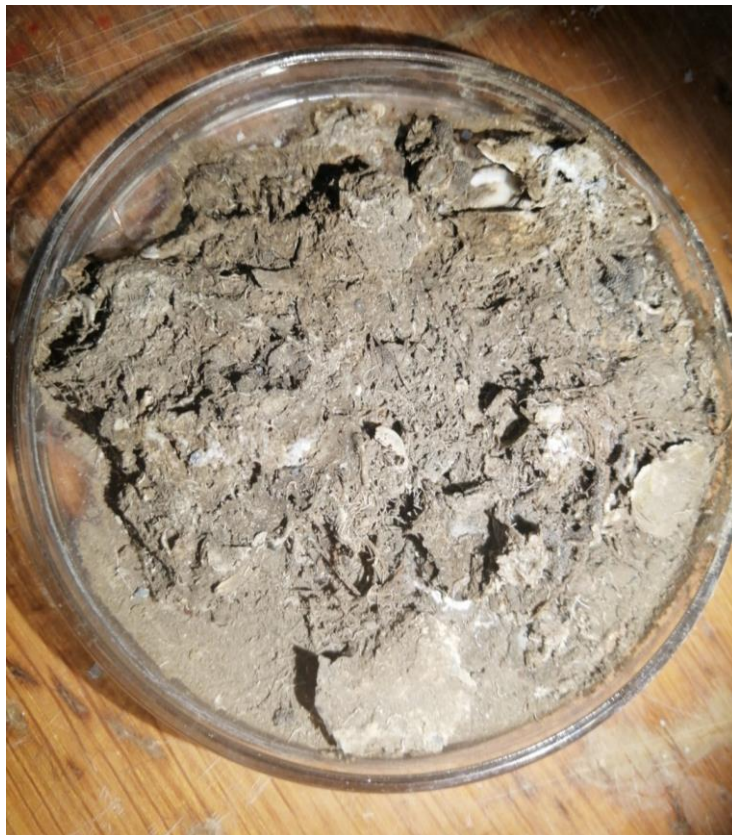
Slika 3.8.6.1. Sadržaj jednog kolektora nakon sušenja u svrhu određivanje suhe mase
