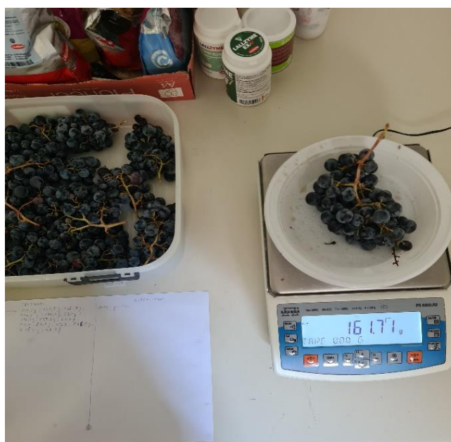
Slika 5. Mjerenje mase grozdova na digitalnoj vagi (Izvor: autor)
