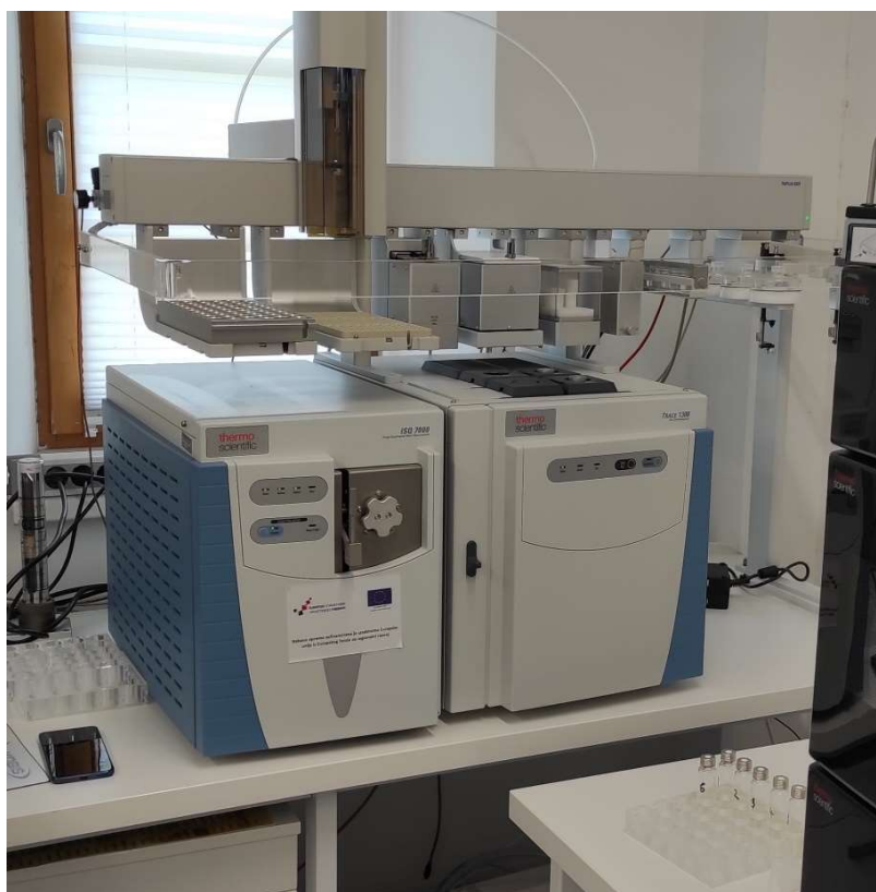
Slika 13. Uređaji plinska kromatografija i spektrometar masa korišteni za analizu hlapljivih aromatskih spojeva
