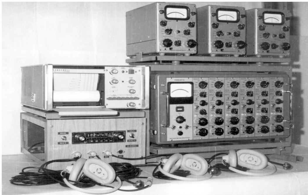
Slika 11. 6-kanalno pojačalo Hottinger-Baldwin uz tri (3) 1-kanalna pojačala, svjetlosni oscilograf sa četrnaest (14) galvanometara Honeywell, komunikacijska oprema). Foto I. Piria
