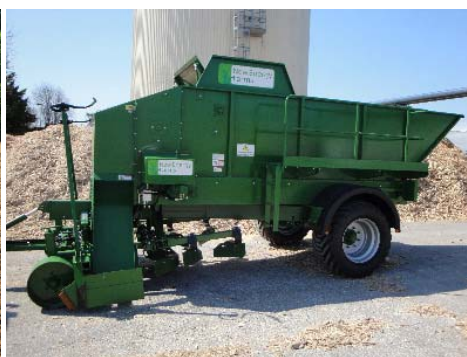
Slika 35. Specijalna automatska sadilica rizoma ( www.newenergifarms.com )
