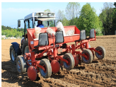
Slika 34. Poluautomatska adaptirana sadilica rizoma
