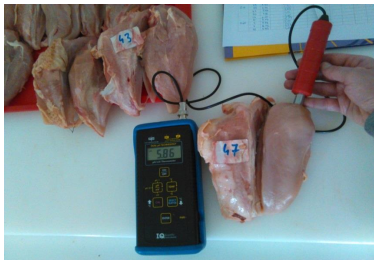
Slika 5. Mjerenje pH vrijednosti (izvor: vlastito istraživanje)
