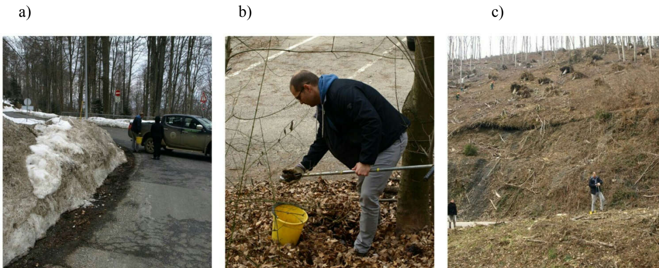
Slika 5.a) zagrebački dio sljemenske ceste tretiran industrijskom soli u zimi b) uzimanje uzoraka tla uz cestu (tretirano tlo) c) uzimanje uzorka tla na netretiranom tlu (kontrola 30 m od ceste) Foto: Kisić, 2015.
