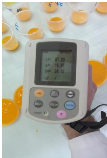
Slika 27. Minolta CR-410 uređaj mjerenju boje žumanjka (Izvor: D. Bedeković)
