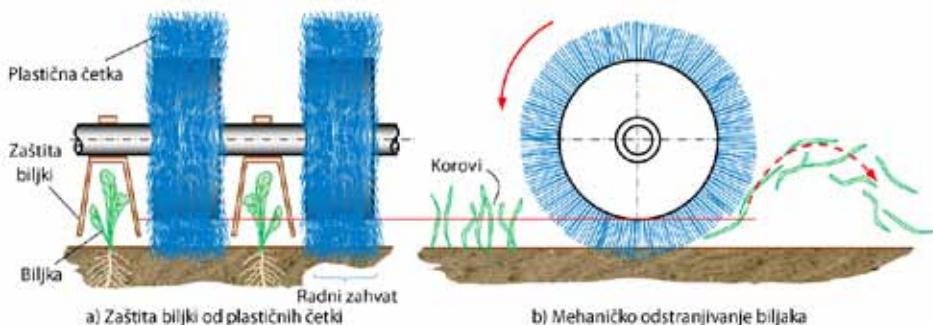
**Slika 9.** Shema rada četkastog kultivatora (Izvor: Vlastita fotografija)
