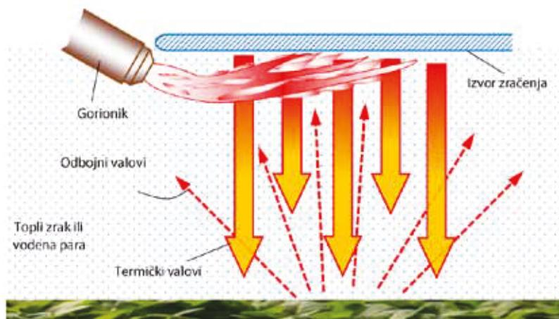
**Slika 3.** Shema rada termičkog kultivatora (Izvor: Vlastita fotografija)
