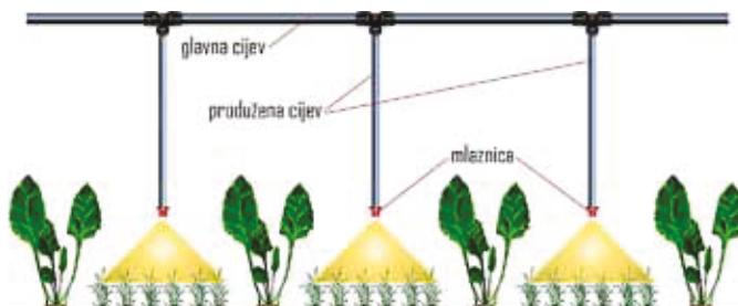
**Slika 1.** Shematski prikaz rada mlaznica na produženim cijevima
