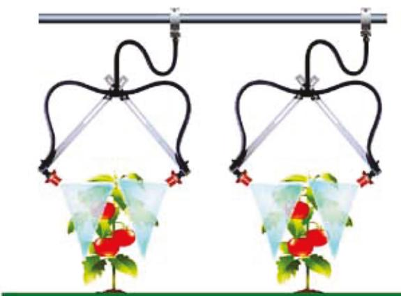
**Slika 2.** Shematski prikaz rada tzv. rednog nosača mlaznica
