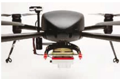
**Slika 7.** RTK senzor ugrađen na bespilotnoj letjelici
