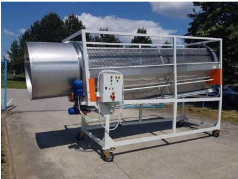
**Slika 2.** Cilindrični separator
