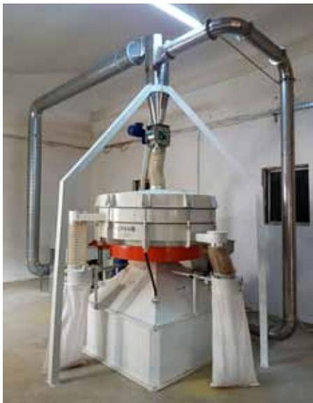
**Slika 7.** Rotacijsko-planetarno sito
