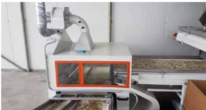
**Slika 8.** Pneumatski separator
