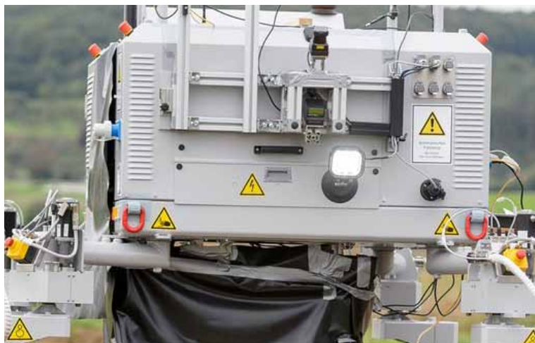
Slika 6. Integrirani višenamjenski robot za primjenu u poljoprivredi BoniRob
