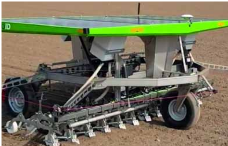
Slika 5. Robot za mehaničko suzbijanje korova FarmDroid FD20
