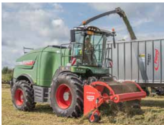
Slika 9. Samokretni krmni kombajn Fendt Katana 85
