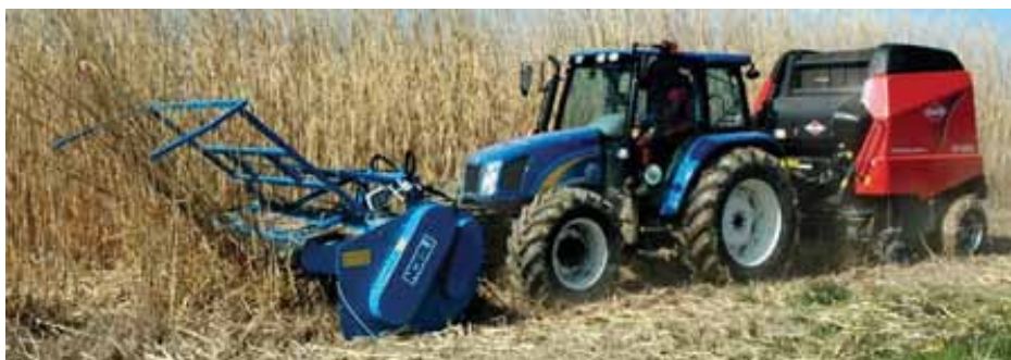
Slika 10. Nobili WS BIO 320 u kombinaciji sa uređajem za prešanje
