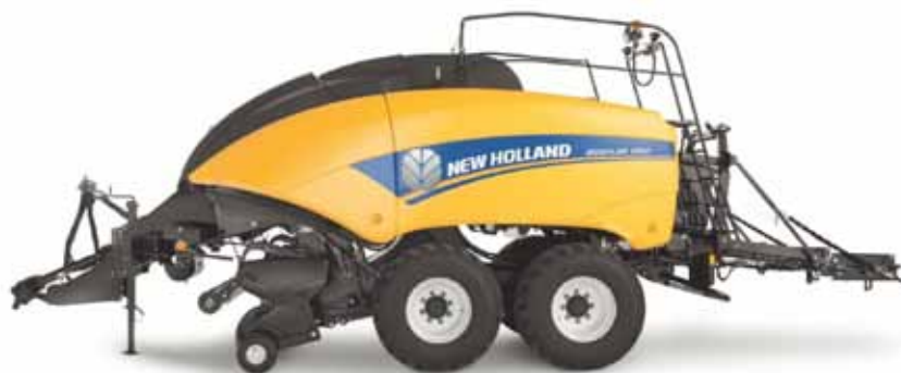
Slika 5. Preša za velike četvrtaste bale Big Baller linija
