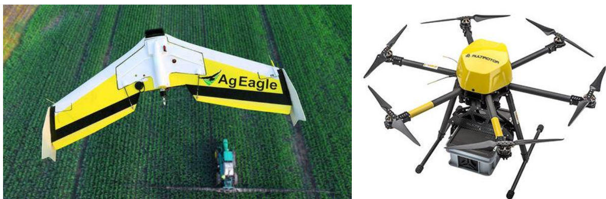
Slika 5.1. UAV s nepokretnim krilima (lijevo) i UAV sa šest rotora (desno).
