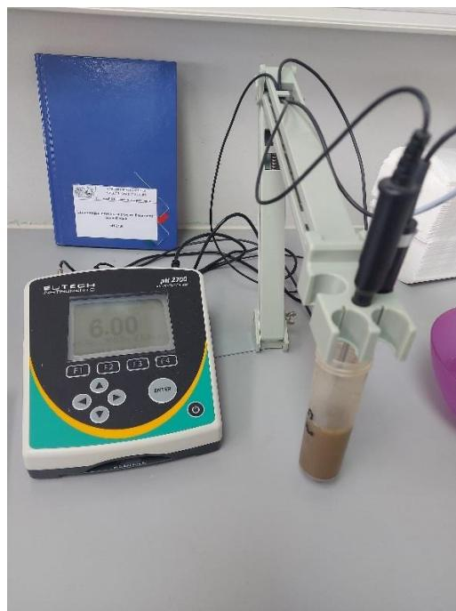
Slika 3.2.3. Postupak određivanja reakcije tla pH-metrom
