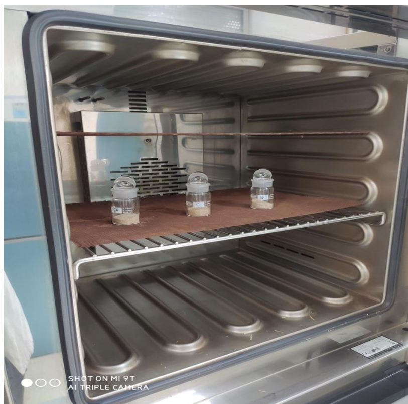
Slika 9. Postavljeni uzorci za sušenje u sušnici
