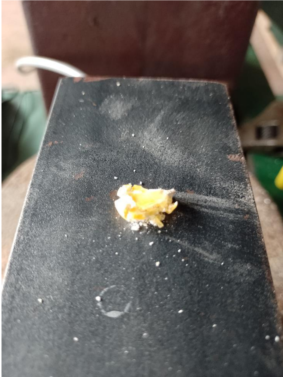
Slika 2.4. Zrno nakon određivanja sile lomljenja
