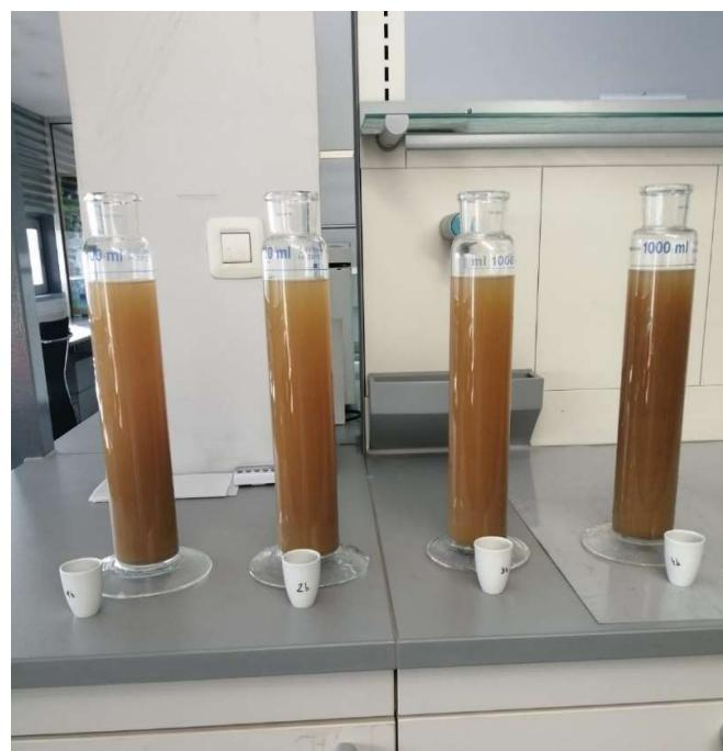
3.3.4. Cilindri za sedimentaciju pripremljeni za pipetiranje praha i gline
