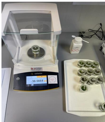
Slika 3.2.1.1. Prikaz vaganja suhe tvari uzoraka (foto: M. Vrbanić)
