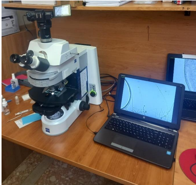
Slika 25. Svjetlosni istraživački mikroskop Zeiss (Zeiss Axio Imager A2).
