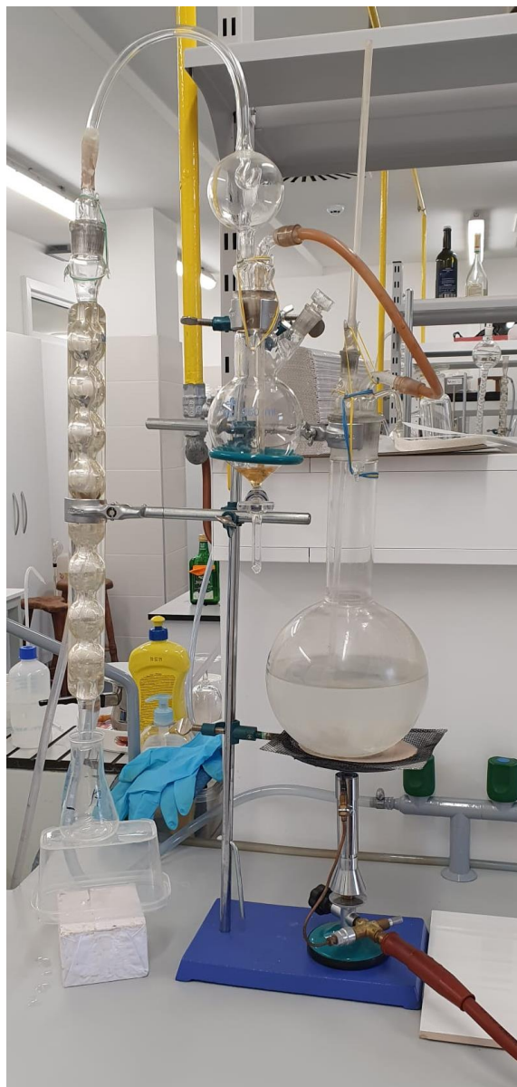
Slika 7. Postupak dobivanja destilata potrebnog za određivanje hlapljive kiselosti (Izvor: Budžaki, 2023.)
