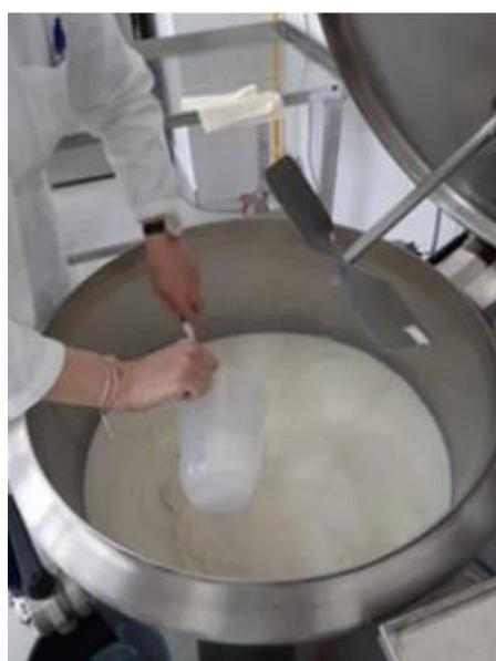
**Slika 3.1.1. Dodavanje sirila u pokušnoj proizvodnji sira škripavca**
