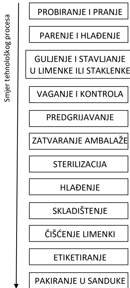
Slika 16. Prikaz tehnološkog procesa izrade pelata
