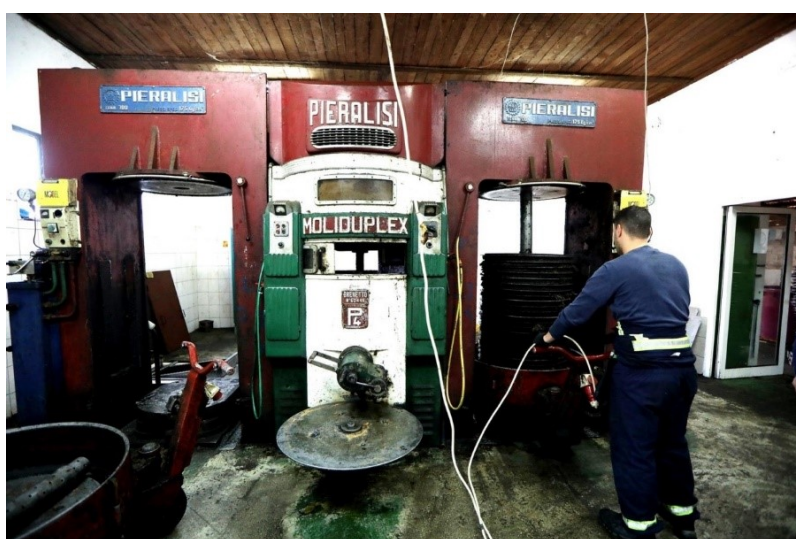
Slika 2.4. Prerada ulja prešanjem u Primoštenu (trofazni način)
