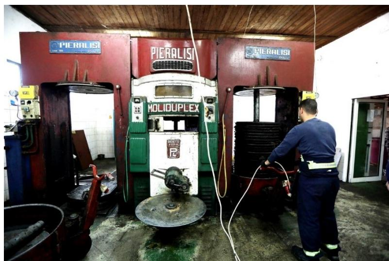
Slika 2.4. Prerada ulja prešanjem u Primoštenu (trofazni način)
