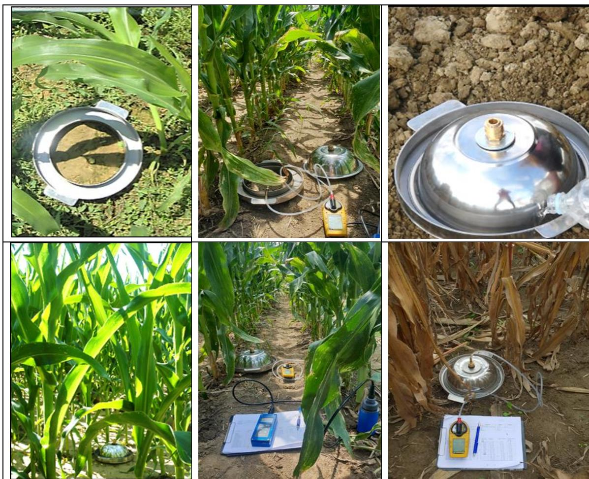
Slika 2.5.1. Mjerenje koncentracije ugljikovog dioksida iz tla
