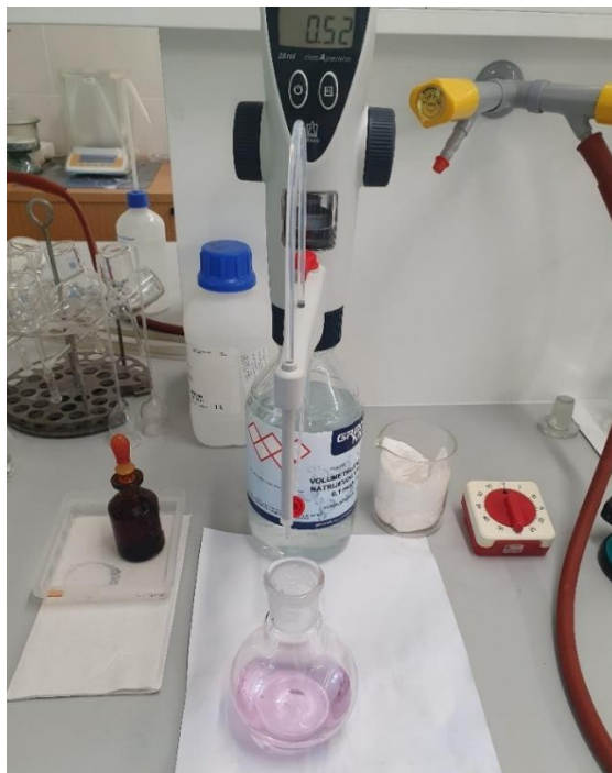
Slika 3.12. Metoda određivanja ukupne kiselosti destilata
