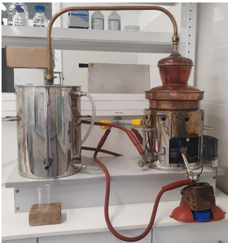
Slika 3.7. Jednostavni destilacijski alambic uređaj kapaciteta 5 L
