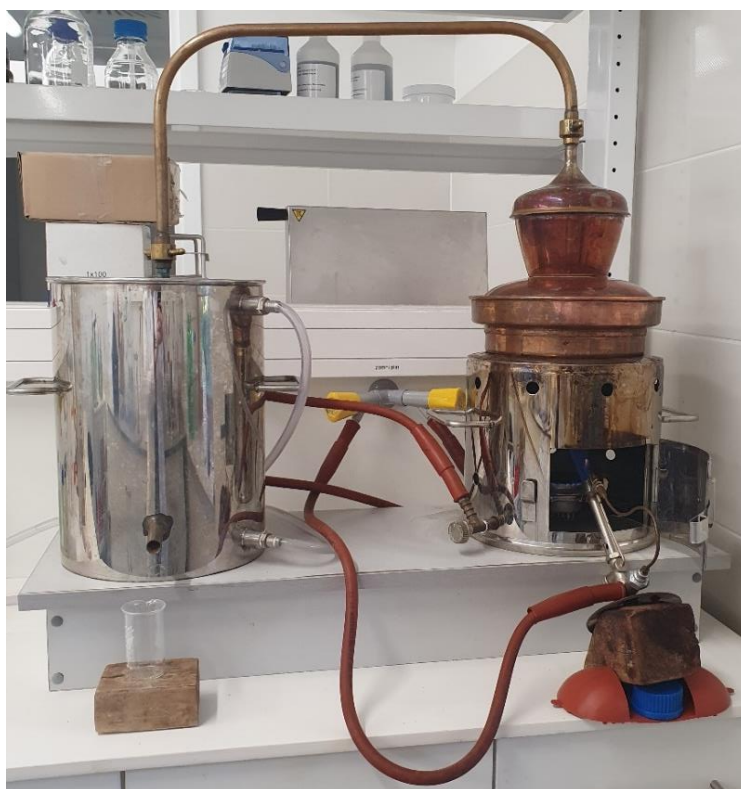
Slika 3.7. Jednostavni destilacijski alambic uređaj kapaciteta 5 L
