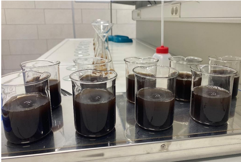
Slika 36. Određivanje stupnja utekućenja – miješanje uzorka na magnetnoj ploči
