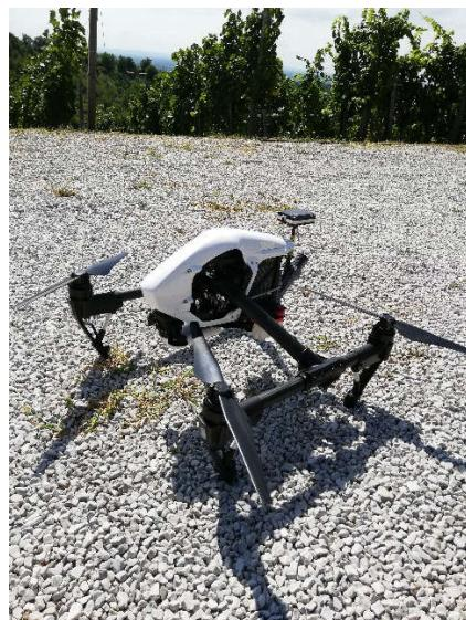
Slika 3. Multirotor bespilotna letjelica (kvadkopter)
