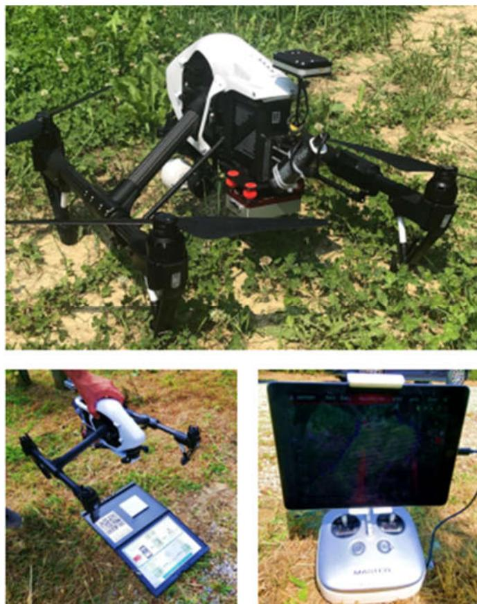
Slika 11. Bespilotna letjelica DJI Inspire 1 Pro opremljena Micasense RedEdge.MXTM multispektralnim senzorom
