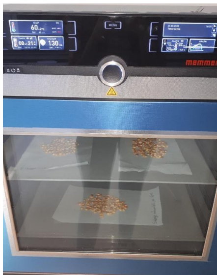
Slika 9. Sušenje zrna kukuruza u Memmert vO101 vakuum sušnici (izvor: vlastiti izvor)
