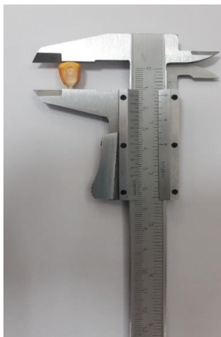
Slika 10. Mjerenje dužine, širine i debljine pomoću šublera (izvor: vlastiti izvor)
