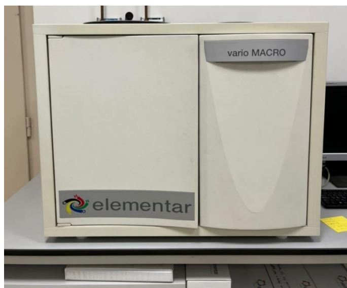
Slika 13. VarioMACRO elementarni analizator (Izvor: vlastiti izvor)
