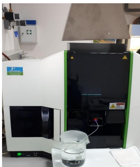
Slika 14: Atomic Absorption Spectrometer (Izvor: vlastiti izvor)
