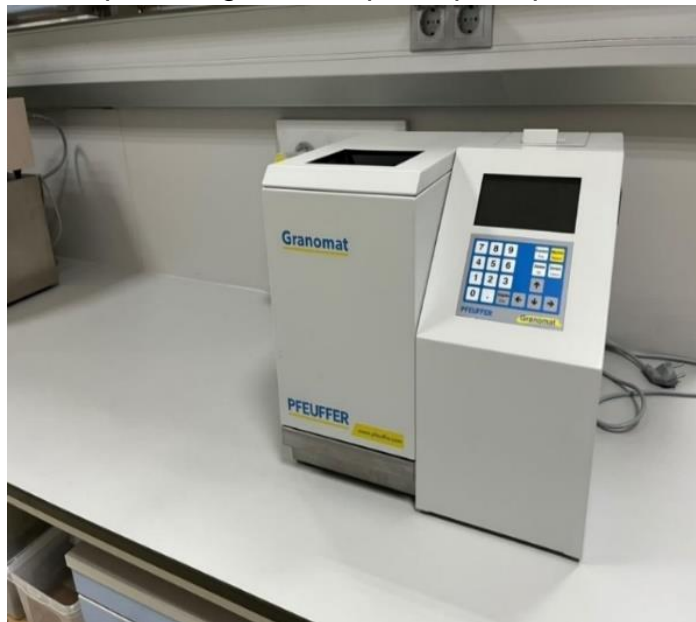
Slika 11. Granomat V1.0. (Izvor: vlastiti izvor)
